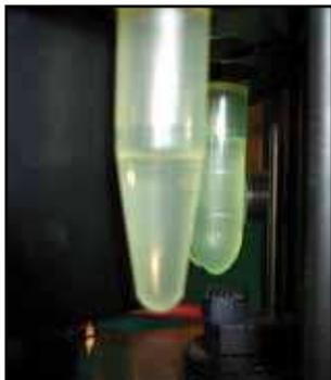
Füllstandskontrolle von Flüssigkeit in Ampullen.
